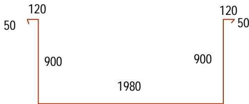
Marca 5, PC 52, Ø10mm, L= 4120 mm, 29 buc.
